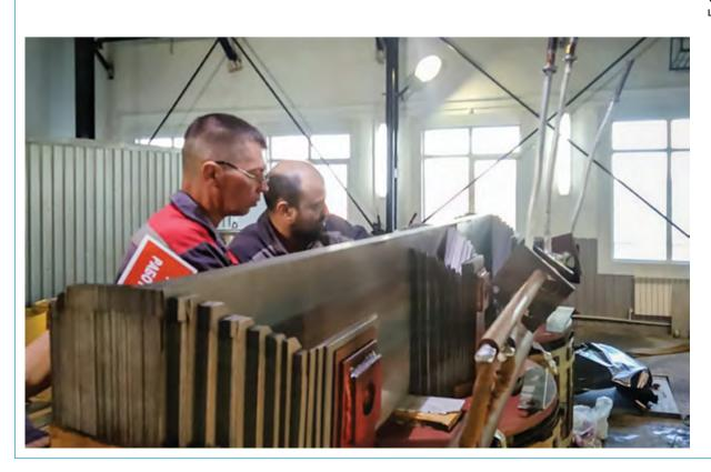
После восстановления (сварки витков, обомоток аргоном) предстояла еще одна творческая работа по сборке листов магнитопровода. Так как такого вида работы гэмовцы производили впервые, работа шла медленно, но с ювелирной точностью»
